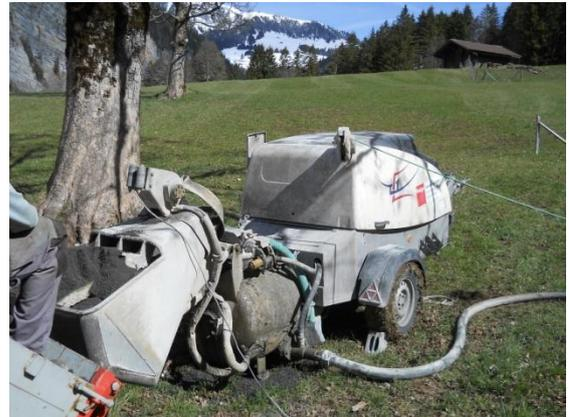
mit dieser Maschine wurde der Sand in den Kugelfang gepumpt
